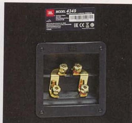
Il diffusore è dotato di doppi terminali di ingresso, utilizzabili per pilotare le due vie in modo separato.
