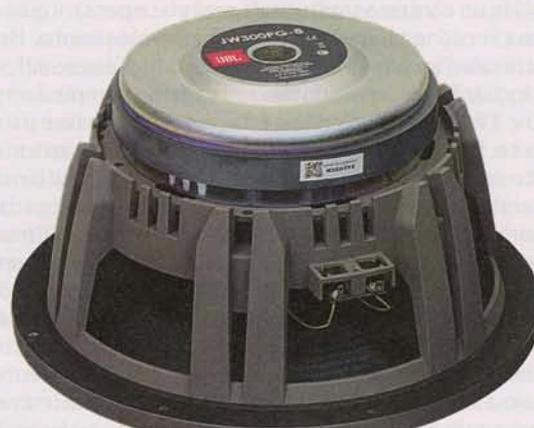
Il complesso magnetico del woofer assicura un buon fattore di forza, grazie anche alla resistenza della bobina mobile di 5,62 ohm. Notare le prese d'aria al di sotto dei due centratori.
