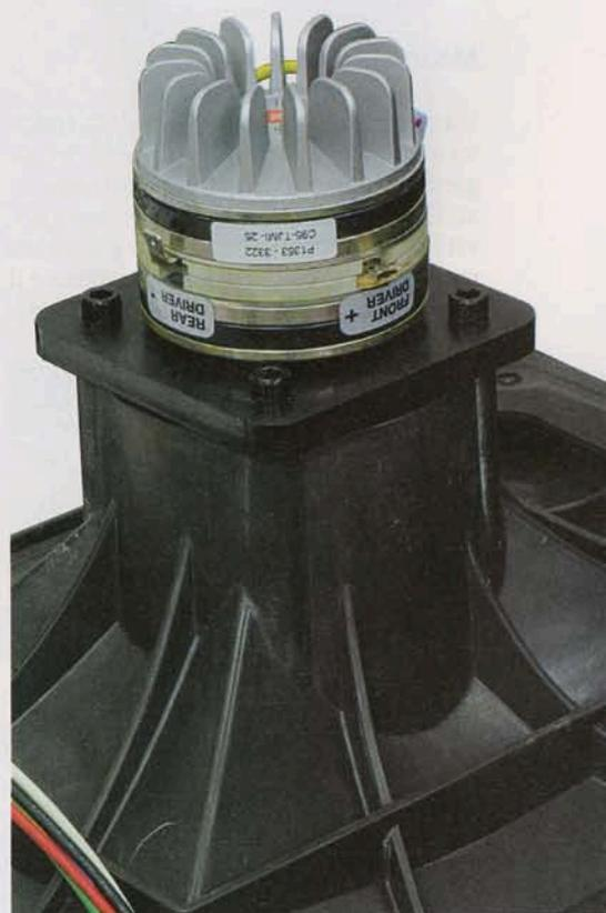
Il driver a compressione è fissato ad una tromba di rigido e sordo Sonoglass, un materiale espressamente studiato per contenere le colorazioni.
